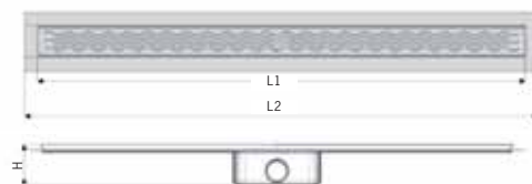
H = 92 mm normál beépítési magasság (50 mm-es búzzár) H = 65 mm alacsony beépítési magasság (30 mm-es búzzár)
